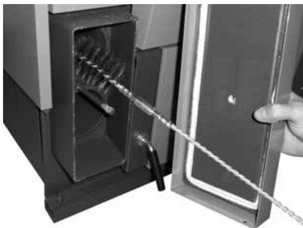
Czyszczenie próbki wymiennika rur za pomocą a szczotka druciana - przednia pokrywka
