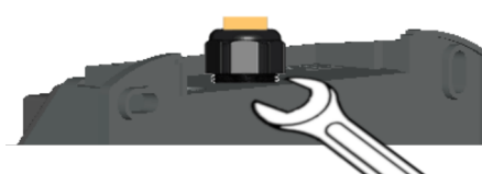
Rys. 6-15: Złącze kablowe śrubowe dociągnąć od tyłu
