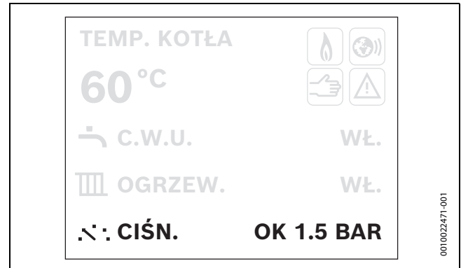
Rys. 5 Odczytywanie ciśnienia roboczego
