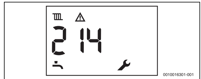
Rys. 82 Przykład: usterka niepowodująca blokady
