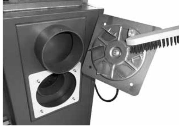
Oczyszczanie koła obiegowego wentylatora spalinowego - kontrola stanu łopatek
